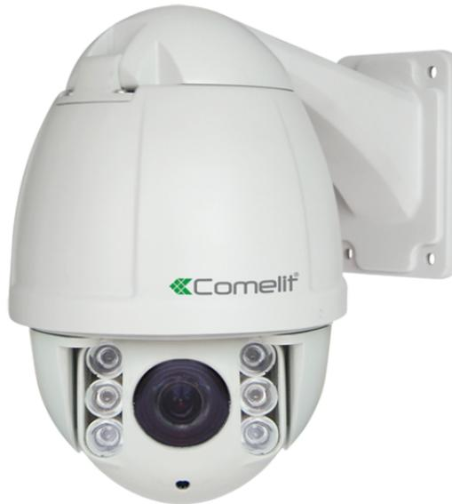
Telecamera dome PTZ AHD all-in-one a colori Day & Night, zoom ottico 20x, risoluzione FULL-HD (1080p), contenitore da 7" waterproof IP66, illuminatori ad infrarosso con portata di 150 metri. Completa di supporto per il montaggio a parete e alimentatore.
