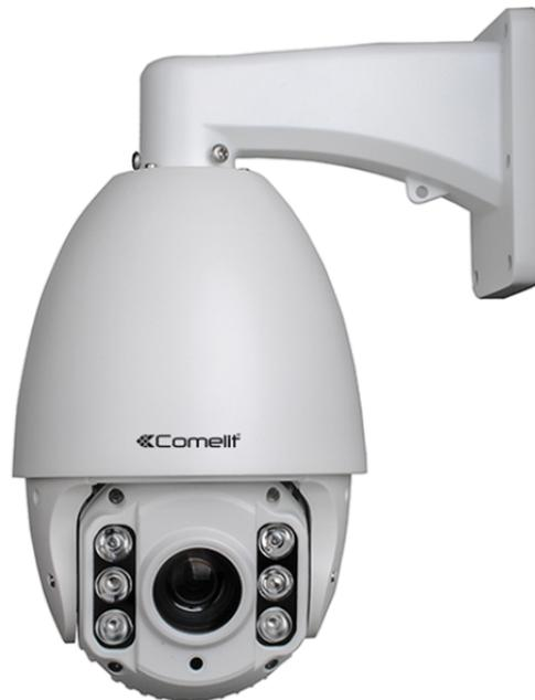
Telecamera dome PTZ AHD a colori Day & Night, zoom ottico 10x, risoluzione FULL-HD (1080p), contenitore da 4" waterproof IP66, illuminatori ad infrarosso con portata di 80 metri (Smart IR), completa di supporto per il montaggio a parete, cavi di collegamento e alimentatore.
