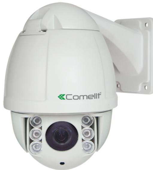
Telecamera dome PTZ 4 in 1 all-in-one a colori Day & Night, zoom ottico 10x, risoluzione FULL-HD (1080p), contenitore da 4.5" waterproof IP66, illuminatori ad infrarosso con portata di 50 metri, completa di supporto per il montaggio a parete, cavi di collegamento e alimentatore.
