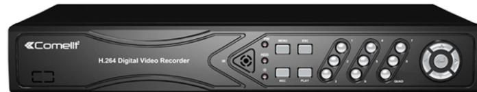
Videoregistratore digitale 5-hybrid stand-alone, 8 ingressi (AHD-TVI: 5MP / IP con telecamere della serie Easy: 4MP / CVI: 2MP / analogici: 960H).
