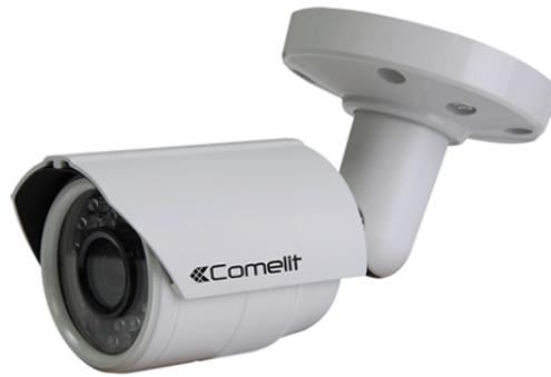
Telecamera AHD bullet a colori Day & Night, ottica fissa da 3.6 mm, risoluzione FULL-HD (1080p), 2 megapixel, contenitore waterproof IP66, 24 illuminatori ad infrarosso con portata di 25 metri.
