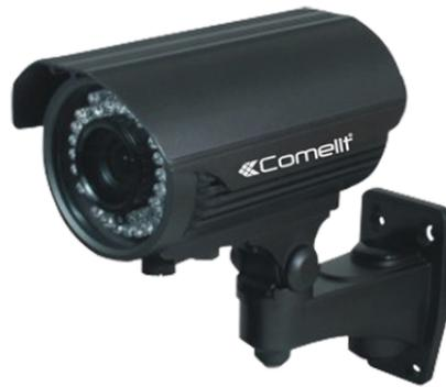
Telecamera AHD/TVI/CVI/CVBS (960H) bullet a colori Day & Night, ottica motorizzata 2.8-12 mm, risoluzione 3MP (AHD/TVI) o 2MP (CVI), contenitore waterproof IP66, 30 illuminatori ad infrarosso SMD con portata di 40 metri.
