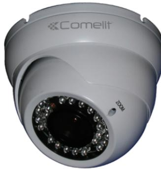
Telecamera AHD minidome a colori Day & Night, ottica varifocal da 2.8-12 mm, risoluzione 960p, 1.3 megapixel, contenitore waterproof IP66, 24 illuminatori SMD ad infrarosso con portata di 35 metri.
