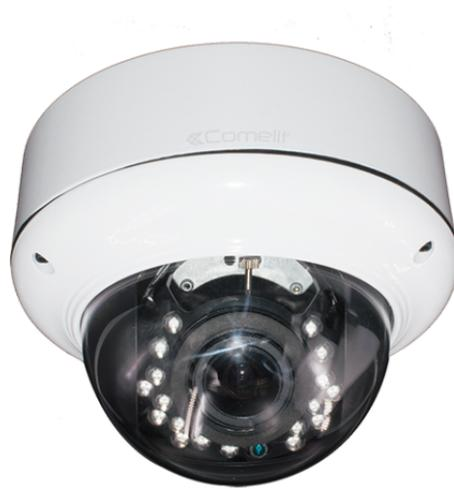
Telecamera AHD minidome a colori Day & Night, ottica varifocal da 2.8-12 mm, risoluzione HD (960p), contenitore waterproof IP66 antivandalo, 18 illuminatori ad infrarosso con portata di 15 metri.
