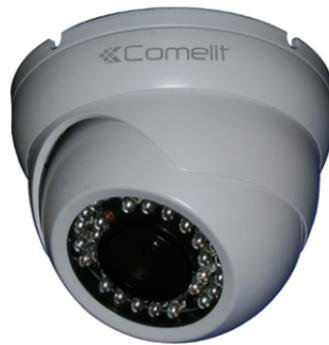
Telecamera AHD minidome a colori Day & Night, ottica fissa da 3.6 mm, risoluzione 960p, 1.3 megapixel, contenitore waterproof IP66, 18 illuminatori ad infrarosso SMD con portata di 25 metri.
