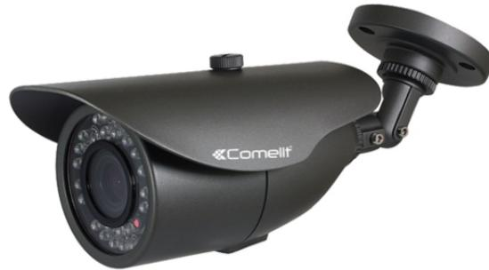
Telecamera AHD bullet a colori Day & Night, ottica con zoom motorizzato da 2.8 - 12 mm, risoluzione FULL-HD (1080p), 2 megapixel, contenitore waterproof IP66, 36 illuminatori ad infrarosso con portata di 30 metri.
