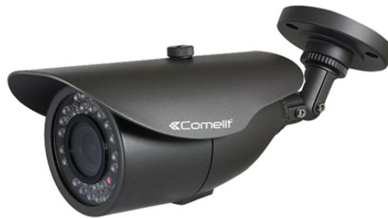
Telecamera AHD/TVI/CVI/CVBS bullet a colori Day & Night, ottica con zoom motorizzato da 2.8 - 12 mm, risoluzione 4/5 megapixel, contenitore waterproof IP66, 24 illuminatori ad infrarosso SMD con portata di 35 metri.
