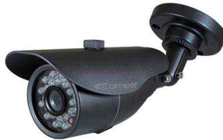
Telecamera AHD bullet a colori Day & Night, ottica fissa da 3.6 mm, risoluzione 3 megapixel, contenitore waterproof IP66, 18 illuminatori ad infrarosso SMD con portata di 25 metri.
