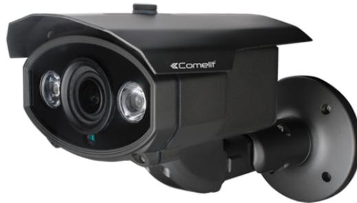
Telecamera AHD/TVI/CVI bullet a colori Day & Night, ottica con zoom motorizzato da 2.8÷12 mm, risoluzione 4/5 megapixel, contenitore waterproof IP66, 2 led array ad infrarosso con portata di 50 metri.
