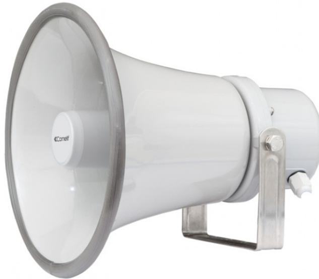
I diffusori sonori a tromba art. 49TRM020 sono caratterizzati da un corpo in alluminio e da staffe orientabili in acciaio inossidabile. Il tipo di costruzione ed i materiali utilizzati ne permettono l'uso anche in esterno o in ambienti particolarmente umidi (es. piscine). Questi diffusori sono stati appositamente sviluppati per essere impiegati in sistemi d'emergenza e d'evacuazione (VES). Morsetti ceramici 49MSC006 per collegamento NON inclusi. Certificazione secondo EN 54-24.
