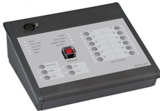
La postazione remota 49BME012 permette, tramite microfono controllato, di inviare messaggi d'emergenza dal vivo o messaggi registrati d'allerta ed evacuazione in zone distinte (massimo 12). I led sul pannello frontale forniscono le principali informazioni sullo stato del sistema d'emergenza e dei guasti. La postazione deve essere completata con il microfono aggiuntivo (non compreso) a scelta fra 49MST002 e 49MPA003 Certificazione secondo EN 54-16
