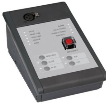
La postazione remota 49BME001 permette, tramite microfono controllato, di inviare messaggi d'emergenza dal vivo o messaggi registrati d'allerta ed evacuazione in chiamata generale. I led sul pannello frontale forniscono le principali informazioni sullo stato del sistema d'emergenza e dei guasti. La postazione deve essere completata con il microfono aggiuntivo (non compreso) a scelta fra 49MST002 e 49MPA003 Certificazione secondo EN 54-16
