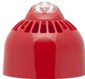
Avvisatore ottico acustico per sistemi antincendio. Montaggio a parete. Copertura(W) 3,1m x 11,3m. Flash bianco LED a basso consumo. Potenza sonora 94-97dB(A). Assorbimento 25mA con frequenza 0,5Hz, 45mA con frequenza 1Hz. Grado di protezione IP21. Dimensioni 100mm (diametro) x 110mm. Certificazione secondo EN 54-3 e EN 54-23.
