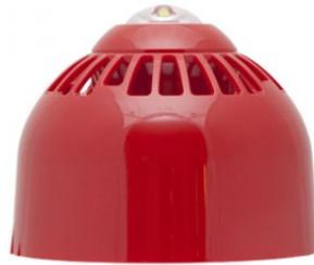
Avvisatore ottico acustico per sistemi antincendio. Montaggio a soffitto. Copertura(C) 3m x 15m. Flash bianco LED a basso consumo. Potenza sonora 94-97 dB(A). Assorbimento 25mA con frequenza 0,5Hz, 45mA con frequenza 1Hz. Grado di protezione IP21. Dimensioni 100mm (diametro) x 100mm. Certificazione secondo EN 54-3 e EN 54-23.
