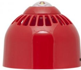
Avvisatore ottico acustico per sistemi antincendio. Montaggio a soffitto. Copertura(C) 3m x 15m. Flash bianco LED a basso consumo. Potenza sonora 94-97 dB(A). Assorbimento 25mA con frequenza 0,5Hz, 45mA con frequenza 1Hz. Grado di protezione IP65. Dimensioni 100mm (diametro) x 117mm. Certificazione secondo EN 54-3 e EN 54-23.
