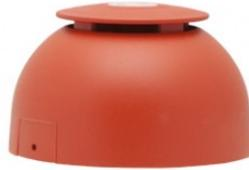
Sirena da interno con elevata resa acustica e basso assorbimento con 3 toni selezionabili. Potenza sonora 90dB a 1m. Consumo max. 7mA. Grado di protezione IP21C. Tensione di alimentazione 9-30 Vdc. Dimensioni 92mm (diametro) x 71mm. Certificazione secondo EN 54-3.
