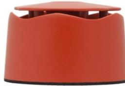
Sirena da esterno con elevata resa acustica e basso assorbimento con 32 toni selezionabili. Potenza sonora max. 110dB a 1m. Consumo max. 39mA. Grado di protezione IP66 (staffa di fissaggio art. 48SAE001 per grado IP66 non inclusa). Tensione di alimentazione 9-30 Vdc. Dimensioni 92mm (diametro) x 95mm. Certificazione secondo EN 54-3.
