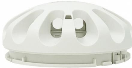
Rivelatore ottico di fumo a sicurezza intrinseca con principio di funzionamento per effetto Tyndall. Progettato per installazioni in locali con atmosfera esplosiva (Zona 0, Zona 1, Zona 2). Da associare alla barriera 48BAZ000. Omologato e conforme alle norme CE 0081 II 1 G Eex ia IIC T6/LCIE 03 ATEX 6350 X e certificazione secondo standard EN54-7.
