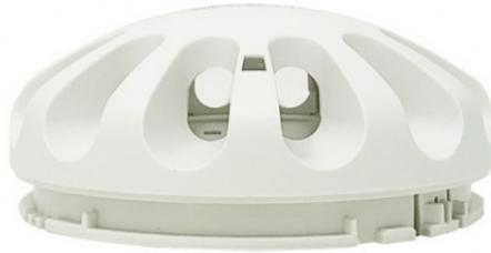
Rilevatore di temperatura a 59 °C e rilevatore di velocità di salita di 9°C/min con sicurezza statica di 59 °C per zone con atmosfere ad elevato rischio di esplosione. Da associare alla barriera 48BAZ000. Tensione: 12-30 V c.c. Assorbimento di corrente in stand by: 120 µA. Omologato conforme alle norme CE 0081 II 1 G Eex ia IIC T6/LCIE 03 ATEX 6350 X e certificazione secondo standard EN54-5.
