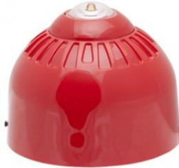
Avvisatore ottico per sistemi antincendio. Montaggio a soffitto. Copertura (C) 3m x15m. Flash bianco LED a basso consumo. Assorbimento 20mA con frequenza 0,5Hz, 40mA con frequenza 1Hz. Grado di protezione IP21. Dimensioni 100mm (diametro)x 100mm. Certificazione secondo EN 54-23.
