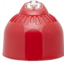
Avvisatore ottico per sistemi antincendio. Montaggio a parete. Copertura (W) 3,1x 11,3m. Flash bianco LED a basso consumo. Assorbimento 20mA con frequenza 0,5Hz, 40mA con frequenza 1Hz. Grado di protezione IP65. Dimensioni 100mm(diametro) x 117mm. Certificazione secondo EN 54-23.
