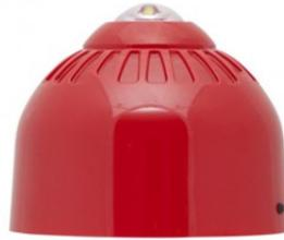
Avvisatore ottico per sistemi antincendio. Montaggio a soffitto. Copertura (C) 3m x15m. Flash bianco LED a basso consumo. Assorbimento 20mA con frequenza 0,5Hz,40mA con frequenza 1Hz. Grado di protezione IP65. Dimensioni 100mm (diametro) x 117mm. Certificazione secondo EN 54-23.
