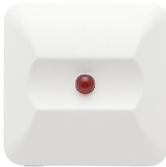
Il segnalatore remoto ripete lo stato dei rivelatori. Compatibile con i sensori e le basi predisposti per questa funzionalità. Tensione di funzionamento: 18Vdc. Corrente assorbita in stato attivo: 30 mA. Sezione dei cavi utilizzabili: 0,4 - 2.5 mm<sup>2</sup>. Temperatura di funzionamento -10°C / +60 C. Umidità relativa di funzionamento: 93 (± 3)% @ 40 °C. Dimensioni:85x85x20 mm. Peso: 42 g.
