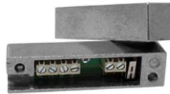
Contatto magnetico per installazione a vista su serramenti, finestre, porte REI. Il collegamento è dato da 5 morsetti interni con contatto in scambio NO/NC. Confezione compresa di viti per il fissaggio del contatto e tappi coprivite a pressione. La distanza di funzionamento di 25 mm in aria libera garantisce funzionamento ottimale su tutte le superfici.
