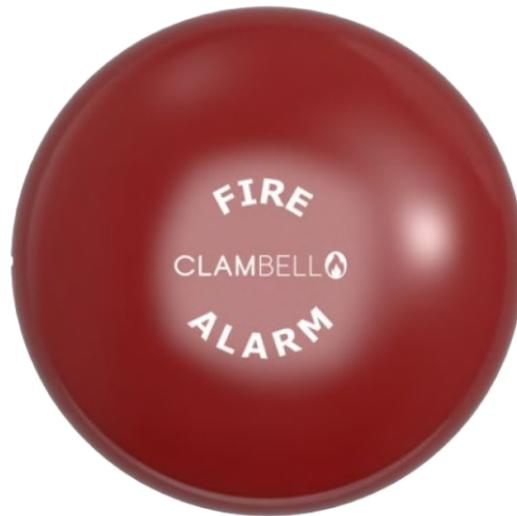
Campana da interno in alluminio con elevata resa acustica e basso assorbimento. Potenza sonora 92-96 dB(A). Consumo di corrente 15mA. Grado di protezione IP21C. Tensione di alimentazione 20 - 27,6 Vdc. Dimensioni 150mm (diametro) x 53mm. Peso 410g. Certificazione secondo EN 54-3.
