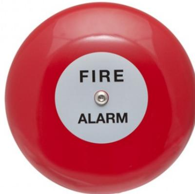
Campana per interno in alluminio con elevata resa acustica e basso assorbimento. Potenza sonora 95 dB(A). Consumo 11mA. Grado di protezione IP33C. Tensione di alimentazione 19-28 Vdc. Dimensioni 150mm (diametro) x 64mm. Certificazione secondo EN 54-3.
