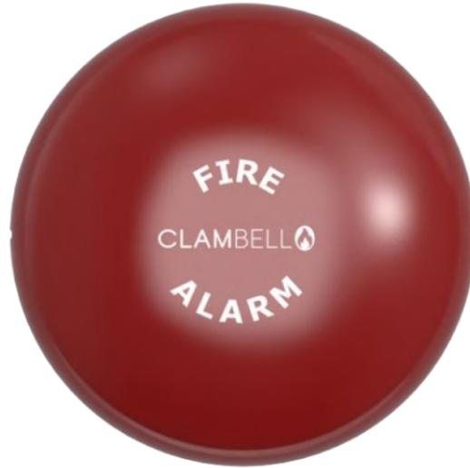
Campana da esterno in alluminio con elevata resa acustica e basso assorbimento. Potenza sonora 92-96 dB(A). Consumo di corrente 15mA. Grado di protezione IP56. Tensione di alimentazione 20 - 27,6 Vdc. Dimensioni 150mm (diametro) x 87mm. Peso 499g. Certificazione secondo EN 54-3.
