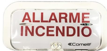
Targa ottico acustica di segnalazione con scritta "Allarme Incendio". Caratterizzata da un basso assorbimento grazie all'illuminazione a LED (luce bianca) ad alta efficienza. Parte acustica multi tono dei quali 7 certificati, modificabili via dip-switch. Predisposta per montaggio a parete o ad incasso parziale. Potenza sonora da 71 a 91dB in base al tono selezionato. Tensione di alimentazione 19-30 VDC. . Certificazione secondo EN 54-3 e EN 54-23.
