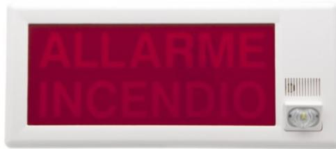
Targa ottico acustica di segnalazione. LED bianco ad alta efficienza lampeggiante. Buzzer integrato con potenza sonora 79dB a 1 metro. Assorbimento 50mA. Copertura per montaggio a parete (W) 4,6m x 9,1m. Copertura per montaggio libero (O) 4,9mx 9,1m x 9,9m. Dimensioni 292x130x68mm. Certificazione secondo EN 54-3 e EN 54-23.
