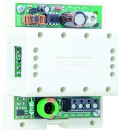
Amplificatore per impianti video Simplebus. Rigenera il segnale di montante relativamente alla componente video. Dotato di microcontrollore per una ottimale gestione di funzionamento. Per il suo utilizzo attenersi alle indicazioni della documentazione tecnica. Alimentazione: 12V AC o 20V DC. Da montare solo su tratta di impianto in ingresso ai miscelatori art.4888 (tratta Simplebus 1). Dimensioni: 66x85x35 mm (4 moduli DIN).
