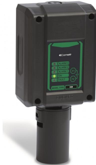
Rivelatore con sensore catalitico per la rilevazione di GPL (gas di petrolio liquefatti). Segnale d'uscita 4÷20mA e cartuccia sensore sostituibile. Alimentazione 12-24VDC. Grado di protezione IP65.
