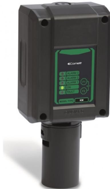
Rivelatore con sensore a cella elettrochimica, per la rilevazione di gas Monossido di Carbonio (CO). Segnale d'uscita 4÷20mA e cartuccia sensore sostituibile. Alimentazione 12-24VDC. Grado di protezione IP65.
