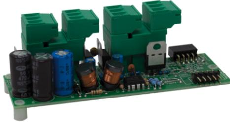
Scheda d'espansione aggiuntiva con 4 uscite a relè, collegabile all' unità remota 47ESP080 (max. 2 espansioni per unità).
