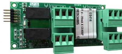
Scheda d'espansione aggiuntiva con 4 uscite relè, collegabile alle centrali art. 47CPG408 (max. 1 espansione) e alla centrale art. 47CPG424 (max. 1 espansione).
