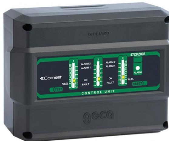
L'art. 47CPZ003 è una centrale adatta per centrali termiche con montaggio a parete, per la connessione di massimo 3 rilevatori remoti di tipo catalitico per gas infiammabili, per gas metano art. 47SE192KM e per gas GPL art. 47SE192KG. La centralina è alimentata da rete (230VAC) o a 24VDC. Grado di protezione IP65.
