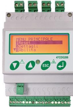
La centrale art. 47CDG206 su guida DIN è utilizzata in sistemi centralizzati d'allarme per parcheggi, industrie e ambienti da proteggere da possibili fughe di gas infiammabili, tossici e ossigeno. Alla centrale possono essere collegati 2 sensori remoti 4÷20mA e fino ad un massimo di 6 sensori con l'utilizzo di 2 espansioni art. 47EDG020. Dimensioni: 4 moduli DIN. Tensione di alimentazione 12-24VDC.
