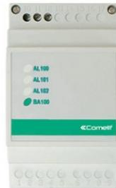
Batteria al litio per centrale art. 47CDG206 che permette un'autonomia di 30/40 minuti se il sistema è in configurazione completa. Può essere installata su guida DIN con evidenti vantaggi in termini di spazio e di costi. Dimensione: 3 moduli DIN. Tensione d'uscita: 10.8VDC. Capacità di 1.7 Ah.
