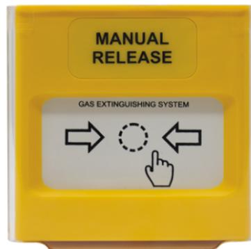
Pulsante manuale giallo per l'attivazione forzata del processo di spegnimento nell'area protetta. La pressione dell'elemento flessibile dà il via all'attivazione del processo di spegnimento. Dotato di copertura protettiva trasparente per evitare attivazioni indesiderate e chiave di riarmo in dotazione. Dimensioni (LxHxP mm) 94x92x60. Materiale ABS. Grado protezione IP40.
