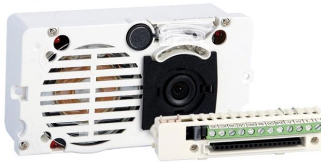
Gruppo audio-video per sistema ViP kit con morsettiera completa di telecamera con obiettivo mini lens a colori orientabile frontalmente, illuminazione telecamera a led. Completo di morsettiera e sistema digitale di gestione della fonica con Eco-cancelling, altoparlante stagno e microfono ad electrete, volume dell'altoparlante regolabile frontalmente. Dimensioni: 102x55x38 mm. Compatibile con formato video H264
