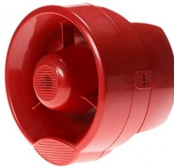
Sirena da installare a parete, da completare con il modulo art. 45MOD000, che ne permette l'impiego in sistemi wireless con certificazione EN54-25. Dotata di 4 livelli di regolazione del volume, e 32 toni differenti impostabili localmente tramite DIP-switch. Potenza sonora 100dB. Dimensioni: 185mm (altezza, base inclusa), 130mm (diametro). Certificazione secondo EN54-3.
