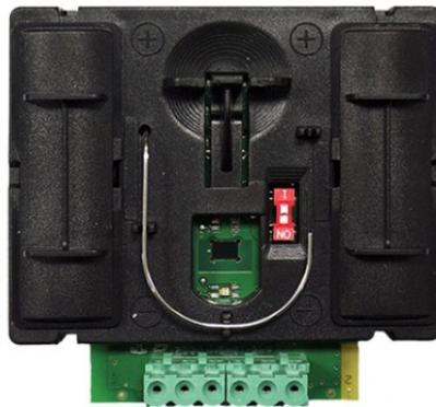
Modulo di interfaccia radio, da installare direttamente all'interno delle sirene 45SAI020 e 45SCI000, consentendone l'utilizzo in un sistema wireless COMELIT. Distanza massima tra il traslatore/ripetitore ed il modulo 200m in campo aperto. Durata vita media delle batterie >3 anni (con impostazioni di default). Tipo di batterie 2 x CR123A (3V). Certificazione secondo EN54-25. .
