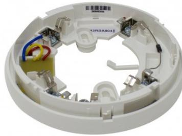
Base con diodo per rivelatori convenzionali, dal design a basso profilo ed un sistema di collegamento al sensore estremamente affidabile consentendo anche un bloccaggio di sicurezza del rivelatore. Compatibile con centrali antincendio, dove la corrente in stato di allarme è  $\geq 45\text{mA}$ . La presenza del diodo consente di rivelare la rimozione del rivelatore dalla sua base. Dimensioni ( $\varnothing$  x H): 102 x 11mm. Peso: 42g.
