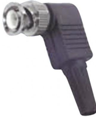
Spina tipo BNC ad angolo retto da avvitare, corpo in ottone nichelato ed isolamento in polipropilene, adatta per cavi art.43751-RG59/U (confezione da 50 pezzi).
