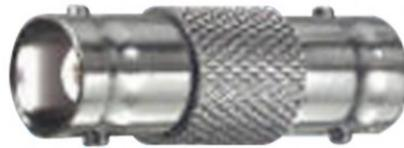
Adattatore da presa tipo BNC a presa tipo BNC, corpo in ottone nichelato ed isolamento in poliestere, adatto per connettori art.43660, art.43661, art.43663 e art.43665 (confezione da 10 pezzi).
