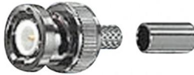
Connettore tipo BNC da crimpare, corpo in ottone nichelato ed isolamento in teflon, adatto per cavo art.43751-RG59/U (confezione da 50 pezzi).
