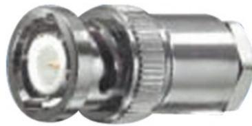
Connettore tipo BNC da saldare e avvitare, corpo in ottone nichelato ed isolamento in teflon, adatto per cavo art.43751-RG59/U (confezione da 50 pezzi).
